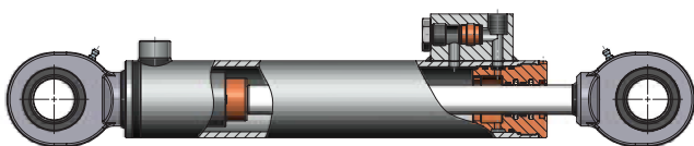
AMORTIGUACIÓN DELANTERA Y BYPASS DE DESPEGUE FRONT CUSHIONING AND STARTING BY-PASS AMORTISSEMENT AVANT ET BY-PASS FRONTDÄMPFUNG UND STARTBYPASS
